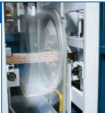
Anello rotante su cuscinetto a sfere Rotating spool unit on ball bearing Drehring auf Kugellager
