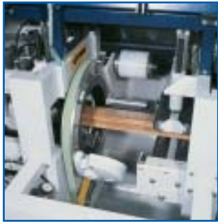
Gruppo aggancio e taglio film ad azionamento pneumatico Pneumatically operated clamp and cutting unit Pneumatisches Folienabschnittsaggregat
